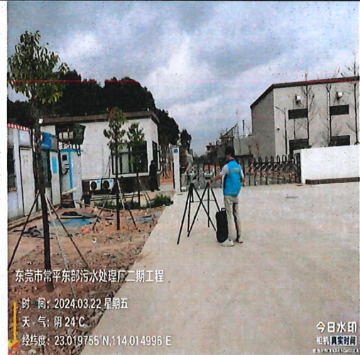
厂界无组织废气上风向参照点 1#
