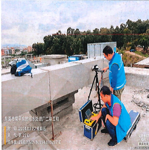
厨房油烟废气排放口
