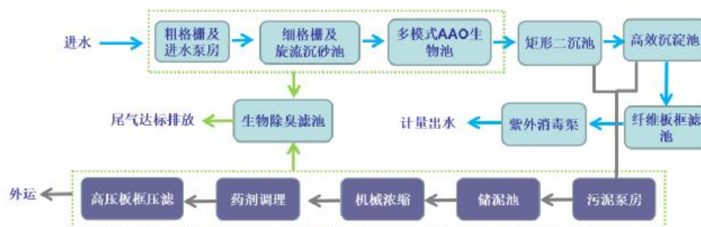
图4.1-41 推荐方案工艺流程图
