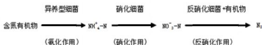
图4.1-13 生物脱氮过程示意图
