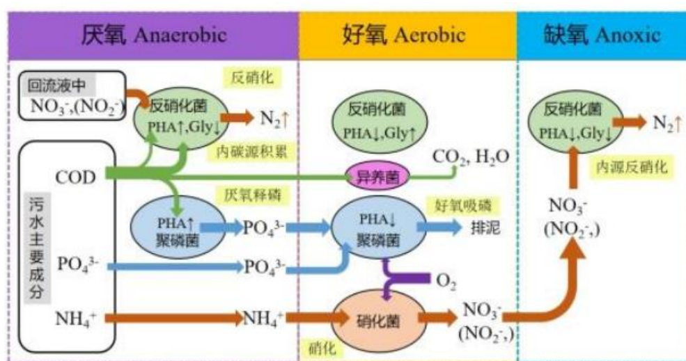
图4.1-19 AOA 工艺污染物去除机理
