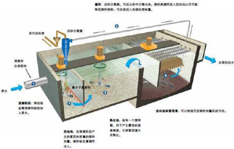
图 5.6-19 加砂沉淀池构造示意图
