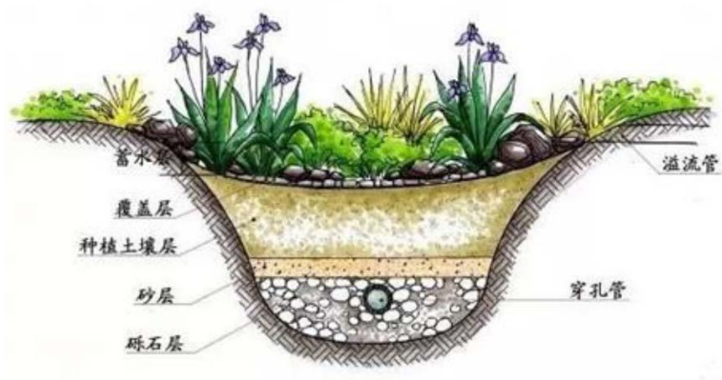
图 6.12-5 生物滞留设施示意图
