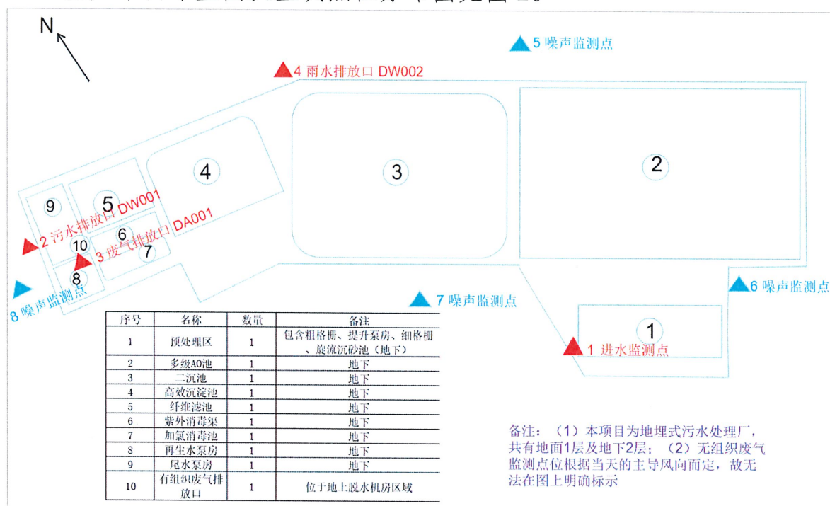
图 2 清溪厦坭污水处理厂平面布置图及监测点位分布图
